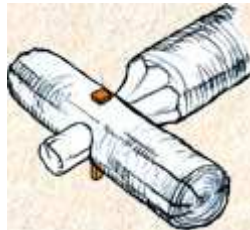
Cheville légèrement carrée sur assemblage tenon/mortaise fixe
